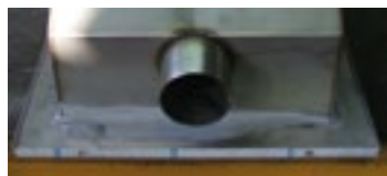
Salida vertical en cubeta soldada
